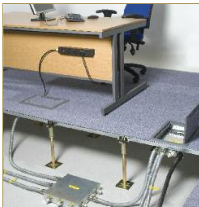
Комплексное решение подачи питания через кабель, бронированный стальной проволокой SWA. Предварительно смонтированная система укладки в технических полах «подключай и работай» подает питание настольным модулям через главный распределительный блок MT32 и напольную коробку.
